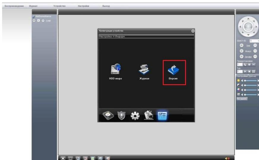
Шаг 5. Определение системной версии и даты прошивки IP-камеры/регистратора.
